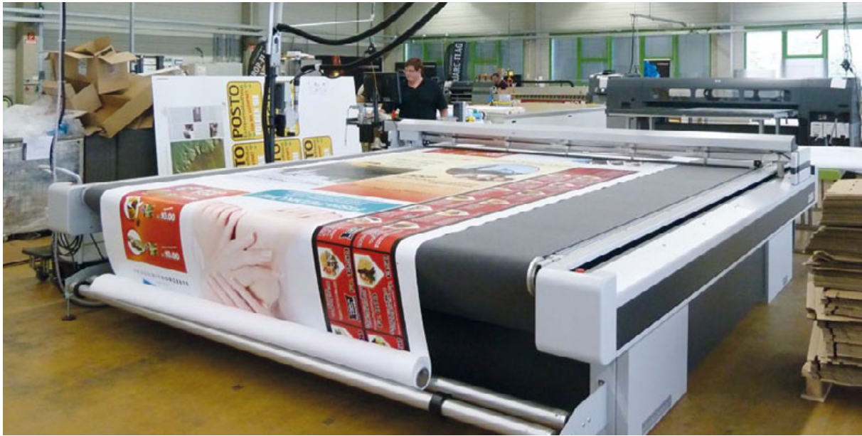
MIT DEM ZÜND-CUTTER werden Werbeschilder und Fahnen auf Kontur geschnitten.
